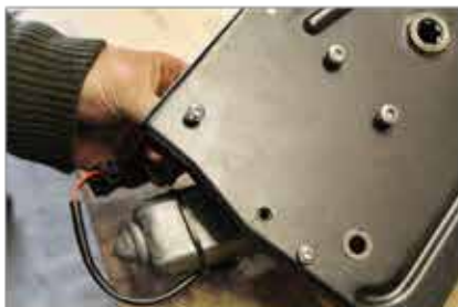
Plaats vervolgens het tandwielhuis op de plaat en schroef de hoekstukken vast.
