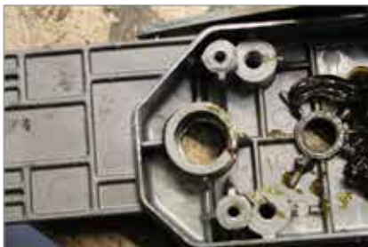
Tegenlager van de achterkant uitnemen.
