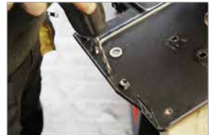
Boor vervolgens de gaten op de markeringen met een 6.5mm boor.
