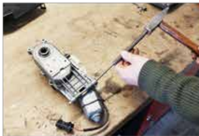
Drijf de oude pen uit het klapmechanisme
