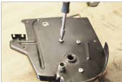
Draai de 4 schroeven los van de houder
