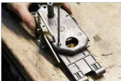
Sluit de behuizing.
