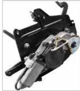
De motor van de kapafdekking
