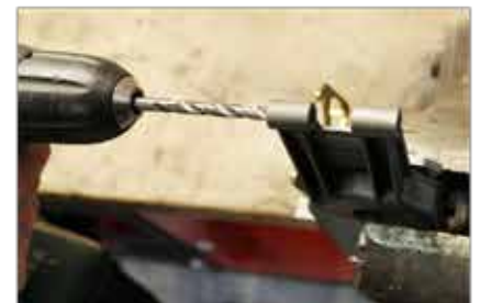
Boor nu de ogen uit met een 6mm boor.
