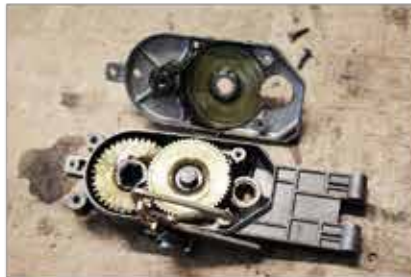
Markeer de positie van de tandwielen ten opzichte van elkaar omdat het druklager er anders niet langs kan.
