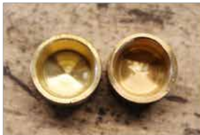
Vergelijk de oude en nieuwe tegenlagers. Op de oude (rechts) is de slijtage te zien.
