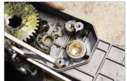
Plaats nieuwe tegenlager en plaats het tandwiel terug.
