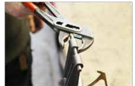
In de meeste gevallen moet het scharnier recht worden gebogen dat kan door voorzichtig op de pen te drukken. Doe dit voorzichtig om de ogen niet afbreken.
